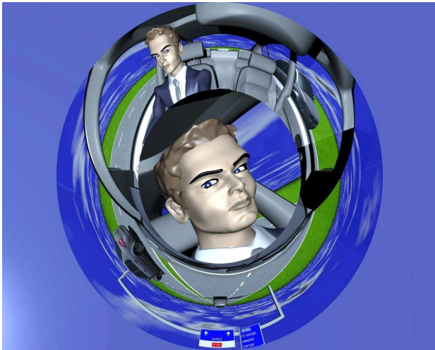
FIG. 7 – Simulation du capteur catadioptrique complet à deux miroirs dans le véhicule pour une vue panoramique de la scène de conduite et une vue à résolution plus élevée pour le visage du conducteur.
