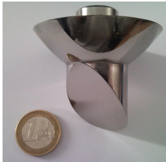
FIG. 8 – Prototype du double miroir.
